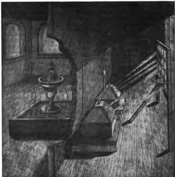
Abb. 104. Sonnenkraftmaschine zum Springbrunnenbetrieb, 1615
